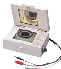
用于测量平板测试物的固有电阻。
