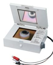
用于测量平板测试物的固有电阻。
