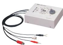
用于测量贴片式电容绝缘电阻的电极。治具可从0mm到11mm任意调整，可测量各种贴片式电容。使用连锁连接电缆连接主机，盖子在开路状态下测量电压为“OFF”。
